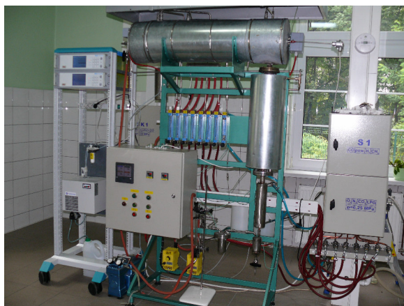
Rysunek 3.2. Widok instalacji badawczej z reaktorem z inertną przegrodą ceramiczną.
